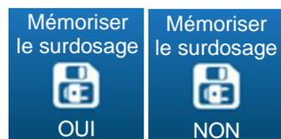
Ce bouton permet d'activer ou de désactiver la sauvegarde l'alarme surdosage journalière lorsqu'il y a une coupure de courant.
