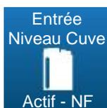
Ce bouton permet d'activer ou de désactiver l'entrée « fond de cuve ». Il permet aussi de choisir le sens du contact NO ou NF. Quand cette entrée est détectée le symbole
