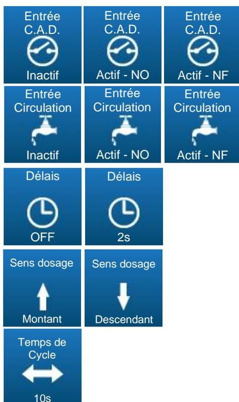
Ce bouton permet d'activer ou de désactiver l'entrée « contact à distance ». Il permet aussi de choisir le sens du contact NO ou NF.
