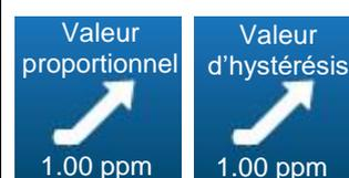
Lorsque le sens de dosage de la voie Chlore est configuré en mode montant, suivant le mode de régulation choisi précédemment, ce bouton permet de choisir la valeur de la bande proportionnelle ou la valeur d'hystérésis.
