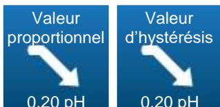
Lorsque le sens de dosage de la voie pH est configuré en mode descendant, suivant le mode de régulation choisi précédemment, ce bouton permet de choisir la valeur de la bande proportionnelle ou la valeur d'hystérésis.
