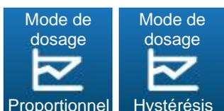
Ce bouton permet de choisir le mode de régulation de la voie pH en mode proportionnel ou en mode hystérésis.
