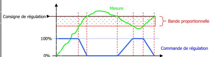
➤ En mode hystérésis, dès que l'erreur (consigne – mesure) est supérieure à la valeur d'hystérésis le besoin de régulation est de 100%.
