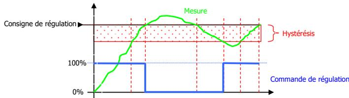
➤ En mode hystérésis, dès que l'erreur (consigne – mesure) est supérieure à la valeur d'hystérésis le besoin de régulation est de 100%.
