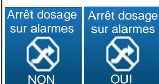
Ce bouton permet d'activer ou de désactiver la coupure du dosage lorsqu'il y a une alarme technique sur le régulateur (Alarmes de mesures haute ou basse).
