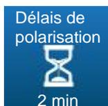
Ce bouton permet de saisir un délai de démarrage du capteur de pH entre 0 et 480 secondes. Cette temporisation permet de retarder la mise en route de la régulation et le traitement des alarmes suite au démarrage de l'appareil ou à une déconnection du capteur. Durant cette phase le symbole
