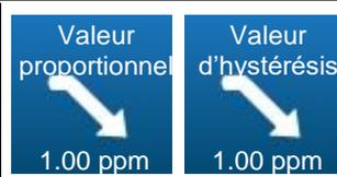
Lorsque le sens de dosage de la voie Chlore est configuré en mode descendant, suivant le mode de régulation choisi précédemment, ce bouton permet de choisir la valeur de la bande proportionnelle ou la valeur d'hystérésis.
