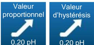
Lorsque le sens de dosage de la voie pH est configuré en mode montant, suivant le mode de régulation choisi précédemment, ce bouton permet de choisir la valeur de la bande proportionnelle ou la valeur d'hystérésis.
