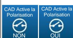
Ce bouton permet de d'activer ou de désactiver la polarisation via le CAD.
