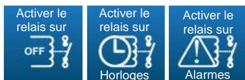
Ce bouton permet de désactiver ou d'associer le relais auto alimenté à une alarme ou à une horloge.
