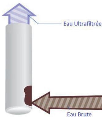
L'utilisation de ce mode de filtration permet de présenter une surface de filtration environ deux fois supérieure à la surface de filtration interne d'une membrane de même dimension.
