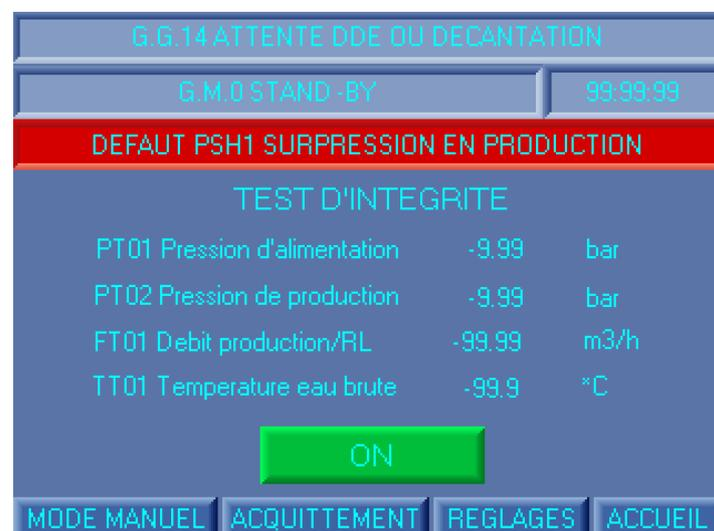
Si la chute de pression est inférieure à 300 mbar, l'écran ci-dessous apparaît.
