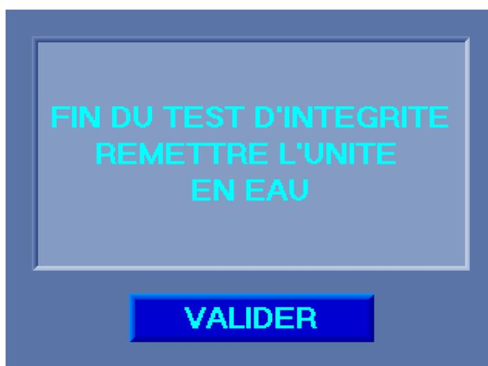
A la fin du test il faut appuyer sur le bouton "Valider" pour poursuivre la séquence par une mise en eau qui permettra d'évacuer l'air du module.
