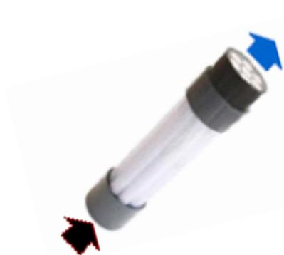
Les modules de filtration frontale Externe / Interne sont donc constitués de ces éléments unitaires et fonctionnent avec une entrée (eau brute) et une sortie (perméat). Ils sont de plus équipés d'aérateurs répartis entre les faisceaux. Certaines phases du rétro-lavage sont aérées : l'injection d'air sous pression permet d'assurer l'agitation des fibres pour un nettoyage optimisé.
