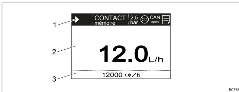
Fig. 5 : Structure de l'affichage permanent
