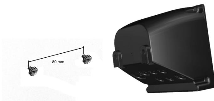
Ou ouvrez l'appareil et fixez-le au mur à travers les trous au fond de l'appareil.
