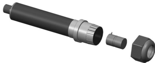
Insérez l'élément capteur dans son support sans exercer de force. Notez que la position correcte est marquée par une entaille. Veillez à ne pas déformer les raccords. Contrôlez l'assise correcte du joint d'étanchéité puis revissez l'écrou.
