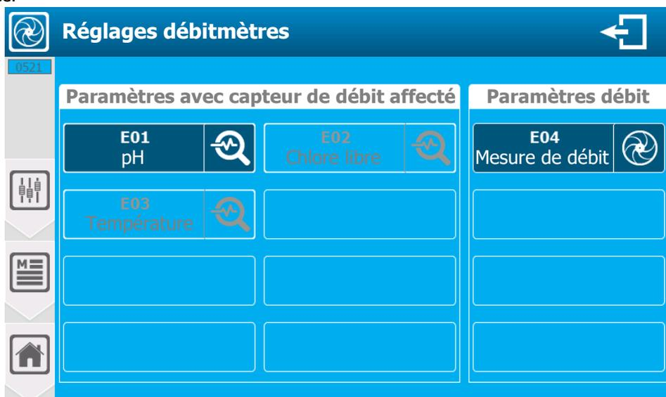
Dans l'exemple ci-dessus le paramètre pH a un capteur de débit affecté en conditionnement. Le réglage de seuils de l'asservissement du débit sera donc propre au paramètre pH.
