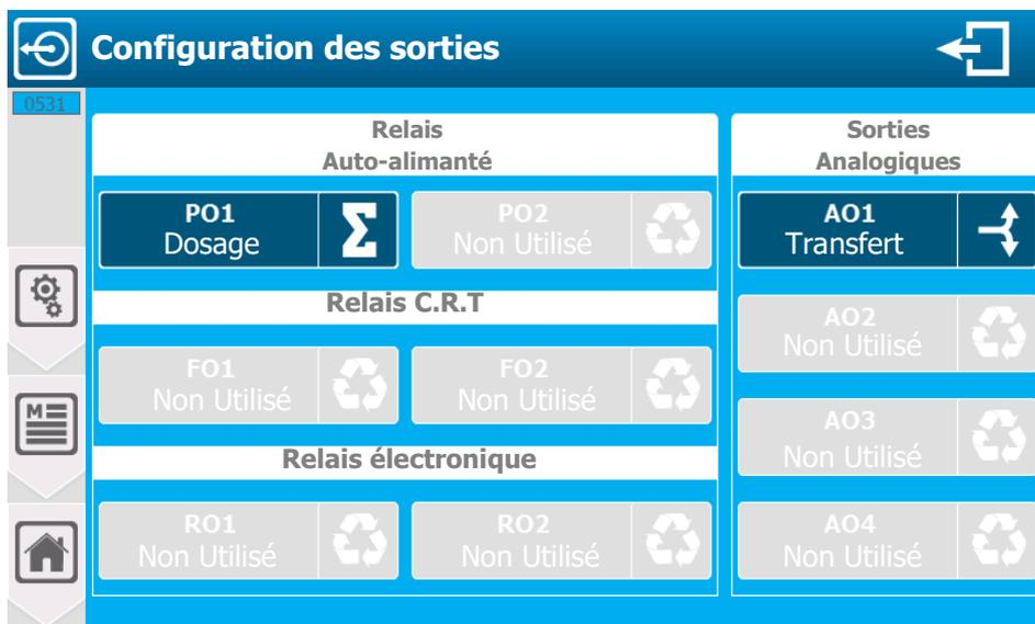
L'écran présente les sorties qui sont déjà paramétrées et celles non utilisées. Vous pouvez en appuyant sur une sortie déjà paramétrée, modifier sa configuration, ou en appuyant sur une sortie non utilisée, configurer son installation.
