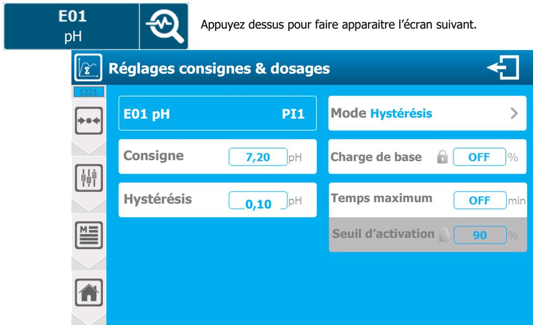
Lorsque le sens de dosage de la voie est configuré en mode descendant, dès que l'erreur (mesure – consigne) est supérieure à la valeur d'hystérésis le besoin de régulation est de 100%.
