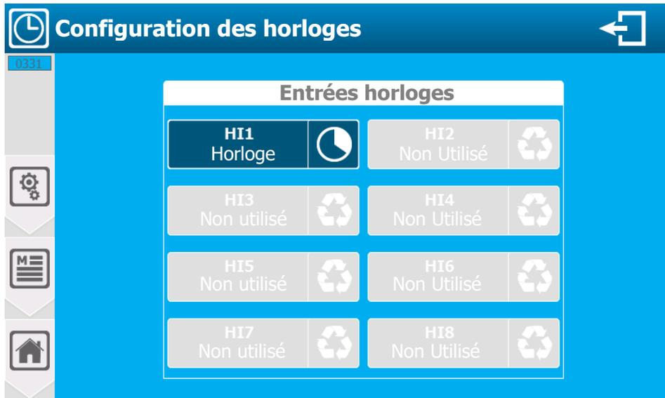
L'écran présente les horloges qui sont déjà paramétrées et celles non utilisées. Vous pouvez en appuyant sur une horloge déjà paramétrée, modifier sa configuration, ou en appuyant sur une horloge non utilisée, configurer son installation.
