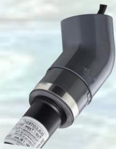
La sonde peut être montée dans toutes les positions. Elle peut être installée directement dans la canalisation via un filetage 1", dans une chambre de mesure 1" via le disque de serrage ou dans une armature d'immersion via le kit de raccordement (raccord fileté 1" + coude 45° DN32) fourni.
