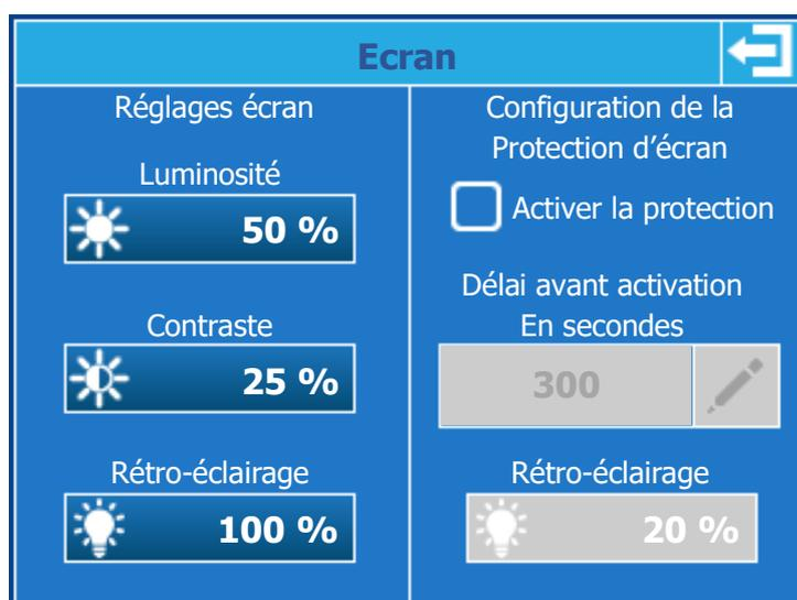
Les réglages de luminosité, contraste et rétro-éclairage sont réalisés par le déplacement du curseur de réglage de gauche à droite en restant appuyé dessus.
