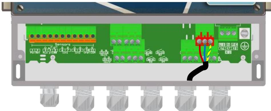
La sortie relais de puissance P3 autoalimentée (Tension d'alimentation primaire = Tension disponible sur P3) sert à la régulation du paramètre pH.
