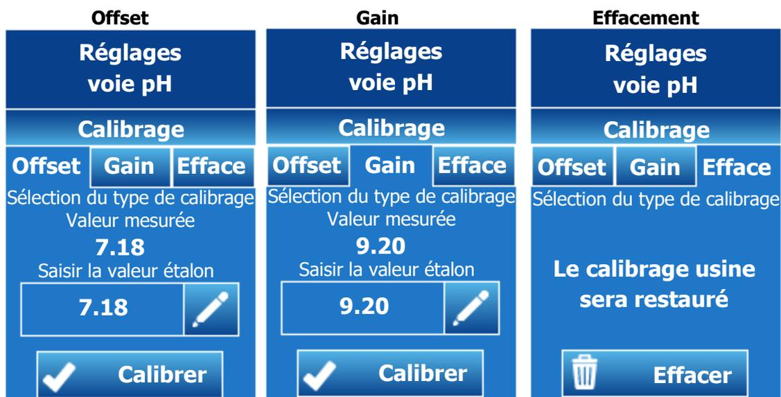
Le principe du calibrage est identique pour la mesure de pH ou la mesure de chlore.
