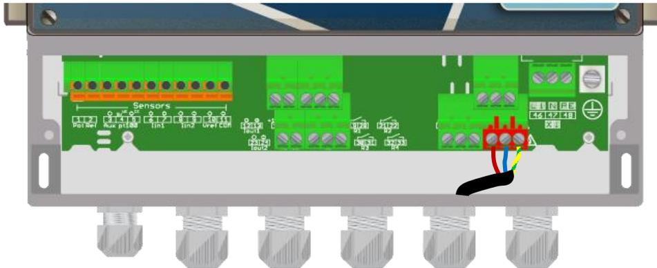
La sortie relais de puissance P4 autoalimentée (Tension d'alimentation primaire = Tension disponible sur P4) sert à la régulation du Chlore / Brome.
