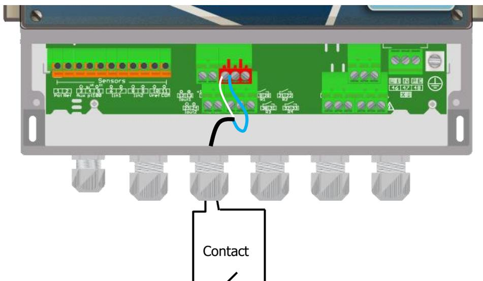
b) Niveau de cuve entrée chlore/brome (K2) :
