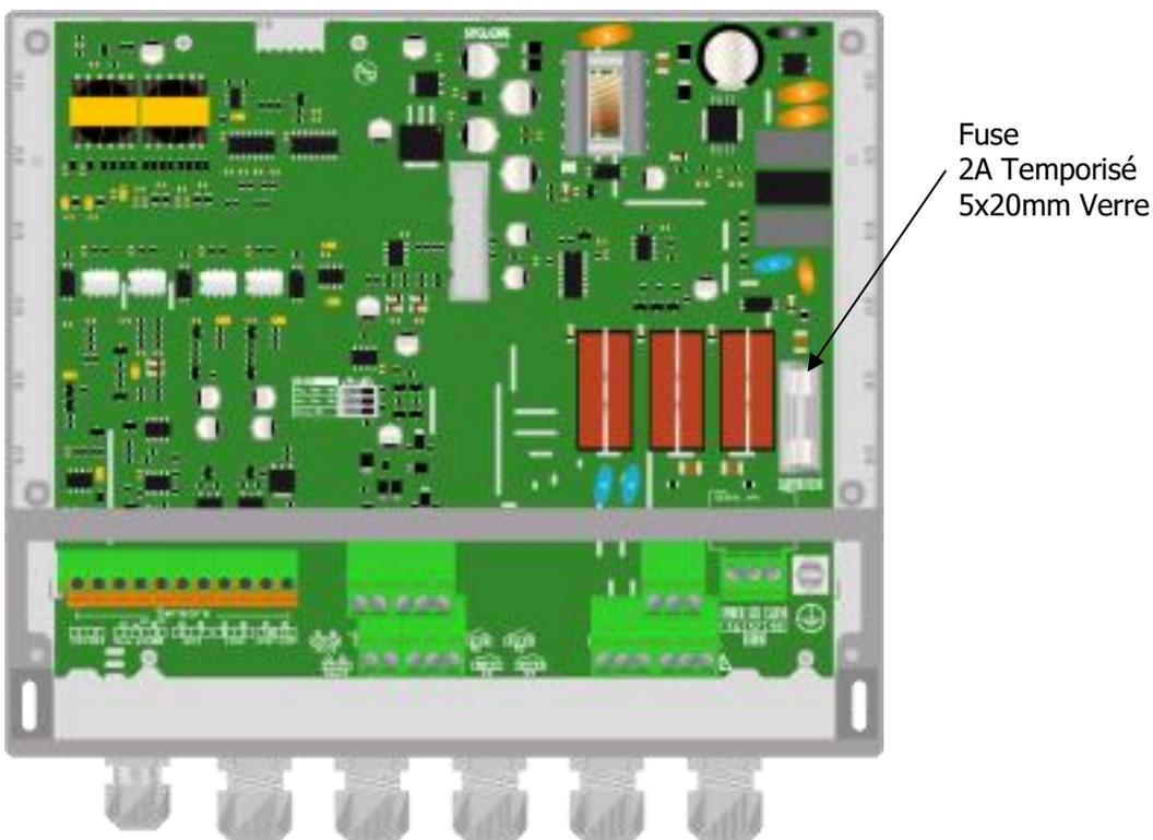
Reconnecter la nappe entre les cartes et remonter la face avant à l'aide des 4 vis de fixation. Ne pas serrer outre mesure car les vis sont fixées dans le boîtier plastique.
