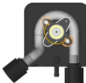
Dégager complètement le raccord de gauche en le maintenant tendu vers l'extérieur puis tourner le porte galet afin de dégager le tube.
