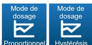
Ce bouton permet de choisir le mode de régulation de la voie Rédox en mode proportionnel ou en mode hystérésis.
