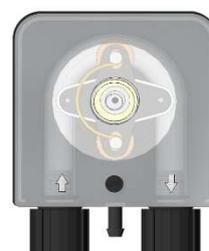
Présenter le couvercle sur la pompe en respectant les flèches, puis visser la vis de fixation de la façade.
