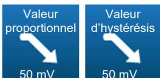
Lorsque le sens de dosage de la voie Rédox est configuré en mode descendant, suivant le mode de régulation choisi précédemment, ce bouton permet de choisir la valeur de la bande proportionnelle ou la valeur d'hystérésis.
