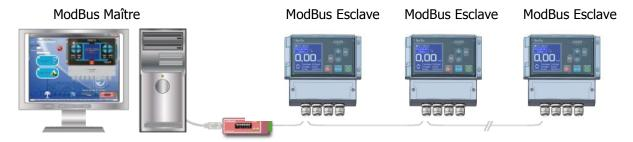
• Connexion d'un ou plusieurs régulateurs **UNIS'EAU** via le BUS RS485.
