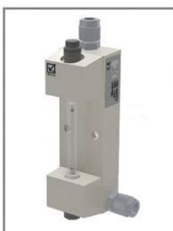
Les débitmètres sont des débitmètres de gaz capables d'ajuster le débit et sont conçus pour des applications agressives. La taille et le type de tube de mesure varient en fonction de la plage de débit et du type de gaz. La bille indique le débit qui peut être lu à partir de l'échelle sur le tube de mesure.
