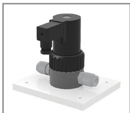
Les électrovannes permettent un dosage simple et économique sans faire d'à-coups sur le surpresseur ainsi que la commande de l'injection de chlore gazeux via le régulateur. Elles garantissent un nettoyage facile : la vanne se démonte simplement en dévissant l'écrou de serrage moleté.
