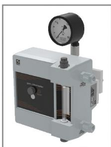
Les régulateurs de vide sont conçus pour le dosage de chlore gazeux. Lorsque l'hydro-éjecteur a généré suffisamment de vide pour surmonter la force du clapet de retenue, le chlore gazeux passe le long de la conduite de vide, par le débitmètre jusqu'à l'hydro-éjecteur, où il est mélangé avec de l'eau de façon homogène.
