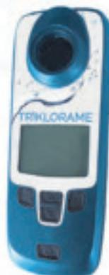
Outil de prélèvement de la trichloramine dans l'air
