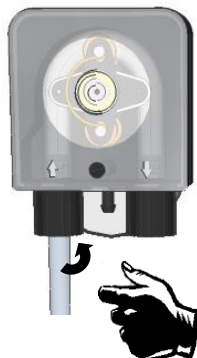
Etape 18 Serrer l'écrou sur la pompe doseuse.
