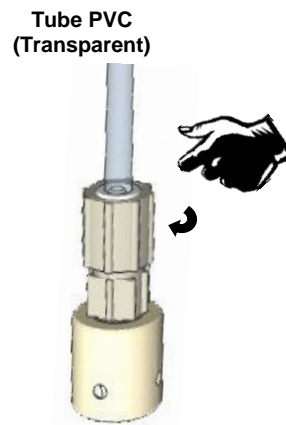
Etape 16 Serrer l'écrou sur le cône.
