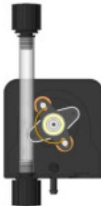
**Insérer le raccord de gauche dans son logement, puis passer le tube sous le guide du porte galet. Tourner le porte galet en accompagnant le tube dans la tête de pompe jusqu'au raccord de droite**
