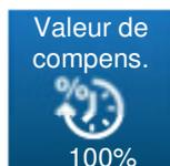
Ce bouton permet de régler la valeur de compensation en température pour 30°C. Le temps de fonctionnement de la pompe sera augmenté de ce pourcentage suivant ce principe :
