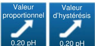
Lorsque le sens de dosage de la voie pH est configuré en mode montant, suivant le mode de régulation choisi précédemment, ce bouton permet de choisir la valeur de la bande proportionnelle ou la valeur d'hystérésis.
