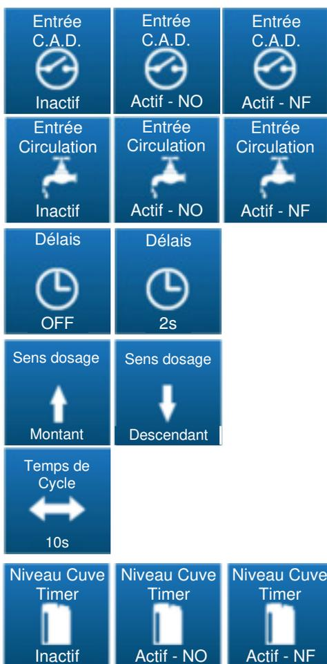
Ce bouton permet d'activer ou de désactiver l'entrée « contact à distance ». Il permet aussi de choisir le sens du contact NO ou NF.
