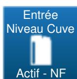
Ce bouton permet d'activer ou de désactiver l'entrée « fond de cuve ». Il permet aussi de choisir le sens du contact NO ou NF.
