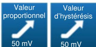
Lorsque le sens de dosage de la voie Rédox est configuré en mode montant, suivant le mode de régulation choisi précédemment, ce bouton permet de choisir la valeur de la bande proportionnelle ou la valeur d'hystérésis.
