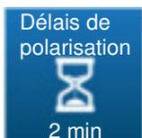
Ce bouton permet de saisir un délai de démarrage du capteur de Rédox entre 0 et 480 secondes.
