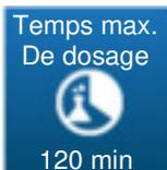
Ce bouton permet de saisir un délai maximum d'utilisation de la pompe associée au capteur de Rédox. Ce temps max est configurable entre 0 (désactivé ou OFF) et 1440 minutes.
