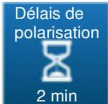
Ce bouton permet de saisir un délai de démarrage du capteur de pH entre 0 et 480 secondes.
