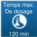
Ce bouton permet de saisir un délai maximum d'utilisation de la pompe associée au capteur de pH. Ce temps max est configurable entre 0 (désactivé ou OFF) et 1440 minutes.
