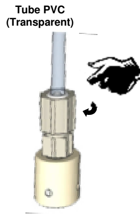
Etape 16 Serrer l'écrou sur le cône.
