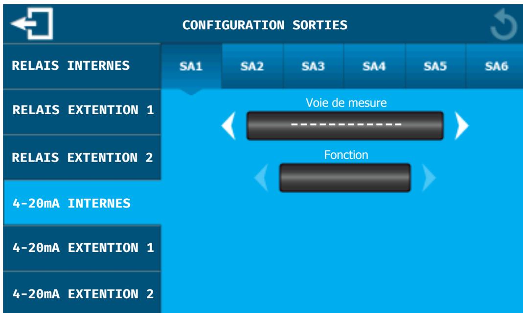
Le bandeau supérieur permet de sélectionner la sortie 4-20mA à programmer.
