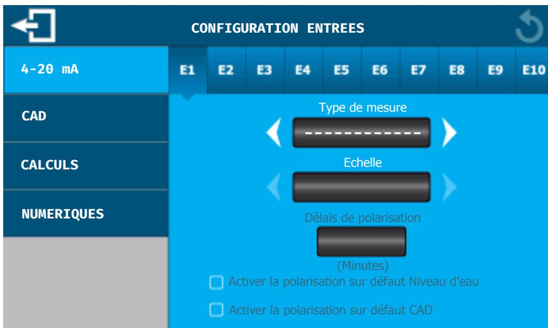
Le bandeau supérieur permet de sélectionner la voie analogique à programmer.
