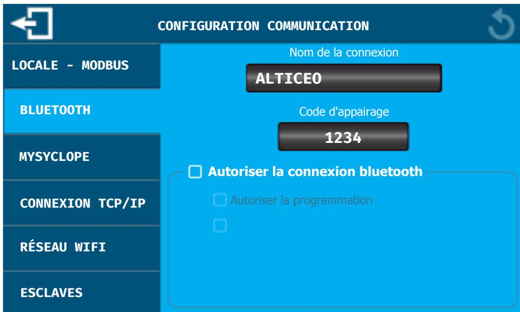
Votre régulateur **SYCLOPE ALTICE'O®** est connectable en Bluetooth avec des appareils mobiles type tablettes ou smartphones équipés de l'application SYSBLUE. Cette application est téléchargeable sur le PlayStore® pour les appareils ANDROID® ou AppelStore® pour les appareils IOS®.
