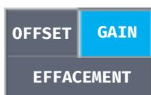
Il est possible de sélectionner le type de calibrage en appuyant sur les trois boutons de sélection.
