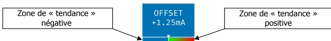
Lors de la saisie d'une nouvelle valeur (Offset et/ou Gain) un bar graph allant du vert au rouge s'affiche, ce qui permet de voir la « tendance » du calibrage. Un calibrage se déplaçant de plus en plus dans la zone rouge peut être un signe de problème sur le capteur de mesure associé.
