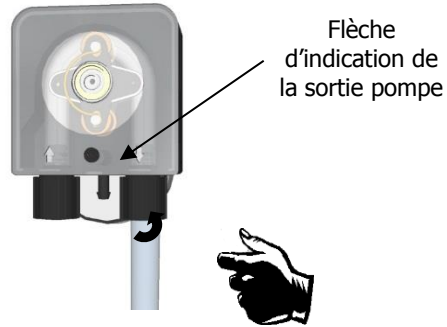
Etape 14 Visser le bouchon avec le tube PE (Blanc) sur la pompe.
