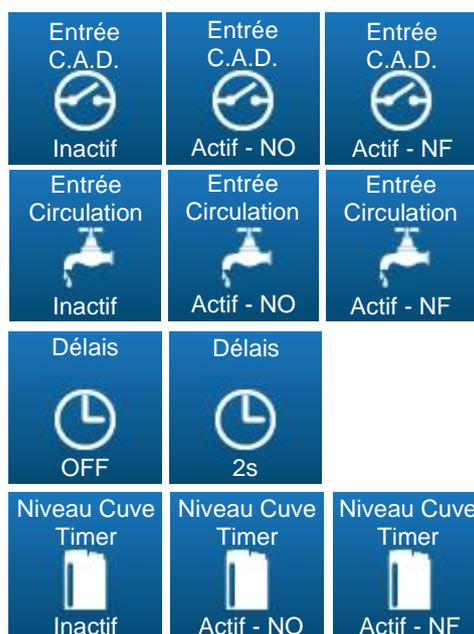
Ce bouton permet d'activer ou de désactiver l'entrée « contact à distance ». Il permet aussi de choisir le sens du contact NO ou NF.
