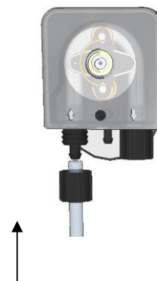
Etape 17 Visser le tube PVC (Transparent) sur la pompe doseuse.
