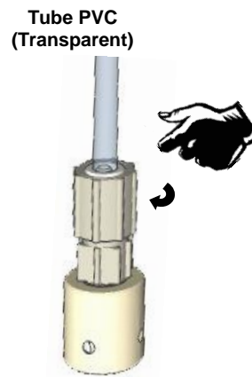
Etape 16 Serrer l'écrou sur le cône. Tube PVC (Transparent)
