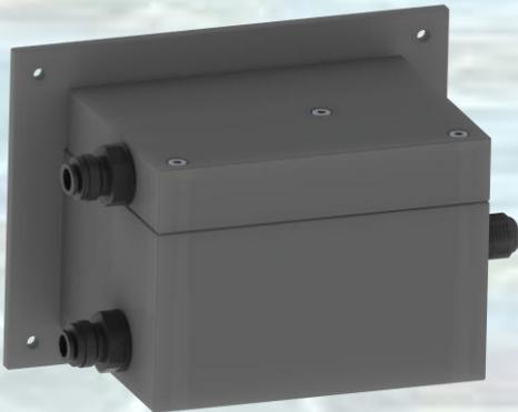
La sonde type TUR20XX permet une mesure de turbidité par rayonnement infra-rouge à 90°. La sonde fournit un signal analogique 4-20 mA permettant le raccordement sur de longues distances.
