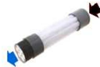
Les modules de filtration frontale Externe / Interne sont donc constitués de ces éléments unitaires et fonctionnent avec une entrée (eau brute) et une sortie (perméat). Ils sont de plus équipés d'aérateurs répartis entre les faisceaux. Certaines phases du rétrolavage sont aérées : l'injection d'air sous pression permet d'assurer l'agitation des fibres pour un nettoyage optimisé.
