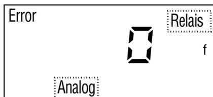
Pour confirmer le message d'erreur, il faut qu'au moins 4 mA soient appliqués sur l'entrée de courant de signal, après quoi, la pompe se remet automatiquement en route et l'indication d'erreur "Error" et le clignotement de l'indication "Analog" s'éteignent.
