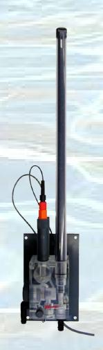
Les chambres de mesure du type CBI0963, CBI1963, CBI2963 et CBI3963 servent à mesurer le brome libre contenu dans l'eau de mer ou le chlore libre actif par méthode ampérométrique ouverte à deux électrodes (Cu/pt), dans les piscines alimentées en eau de mer ou de qualité similaire.
