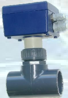
La sonde est programmée et identifiée en usine via un logiciel spécial. Ce dernier permet de la configurer avec la gamme de mesure souhaitée allant de 0,5ms à 1000ms. Elle peut donc être reprogrammée en cas de besoin.
