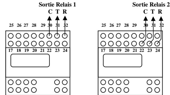
**Attention :** Les sorties relais ne peuvent supporter des puissances importantes. La tension maximum de commutation ne peut excéder 48 Volts (AC ou DC) Le courant maximum de commutation 1A.
