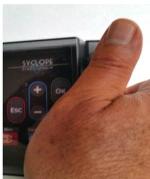
Avec la paume de la main, appuyer sur la porte transparente et serrer avec la main pour verrouiller
