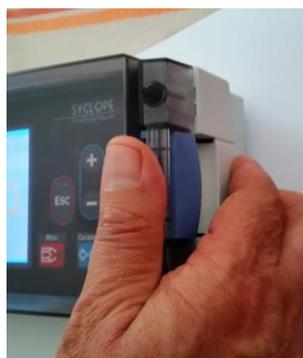
Passer les doigts derrière le verrou, et amener la porte avec le pouce ...
