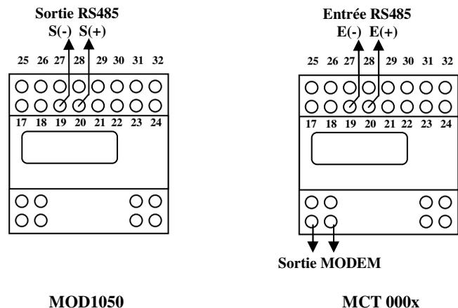
Attention : Les sorties relais ne peuvent supporter des puissances importantes. La tension maximum de commutation ne peut excéder 48 Volts (AC ou DC) Le courant maximum de commutation 1A.
